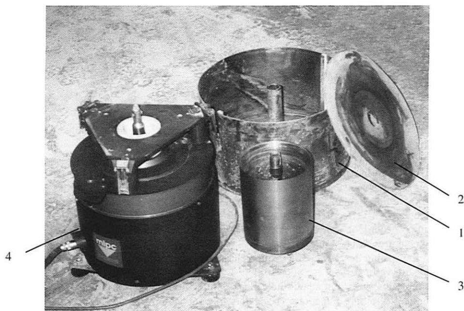
1 – gamelle fixe, 2 – tapis en caoutchouc, 3 – pièce tournante, 4 – bloc moteur Figure III.9 – Tribomètre à cylindres coaxiaux démonté.
