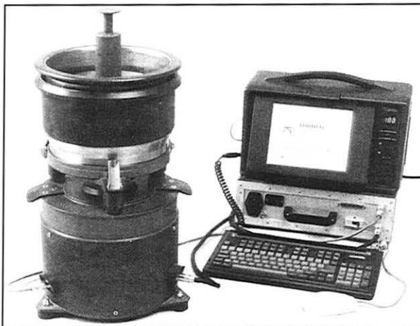
Figure II.45 –Rhéomètre à béton BTRHEOM.
