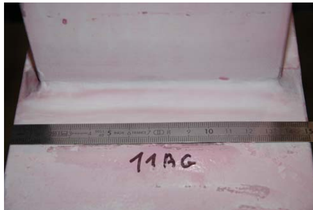
Figure 2.14. Contrôle par ressuage sur éprouvette déposée
