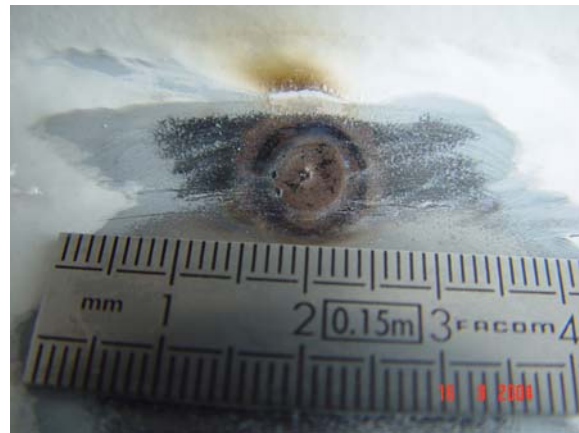
Figure 2.6. Point de soudure TIG sur le cordon de soudure
