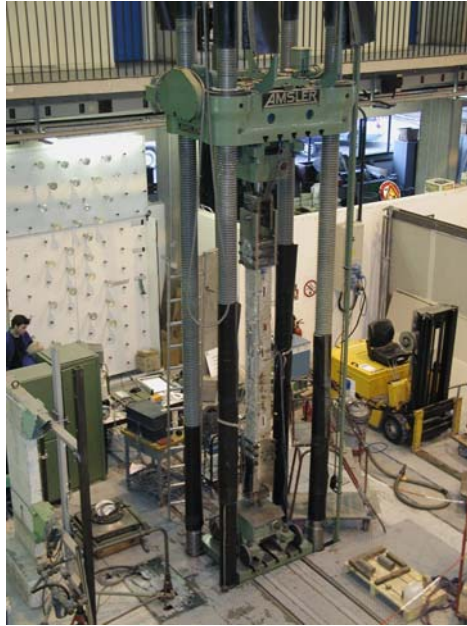
Figure 5.3. Montage expérimental pour les essais de traction
