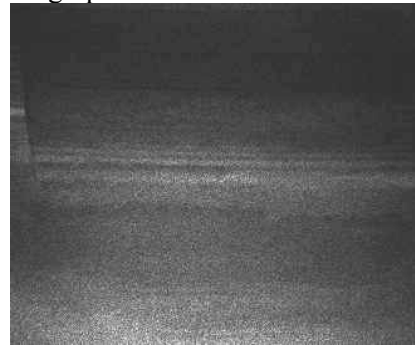
d) Shearographie en temps moyennée pour une sollicitation acoustique à 996Hz
