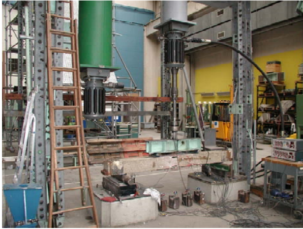
Figure 5.2. Profil de chargement des poutres de la Rance
