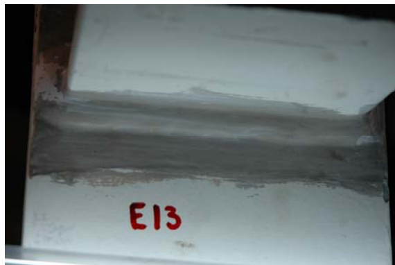
Figure 2.7. Peinture de recouvrement des points de fusion TIG
