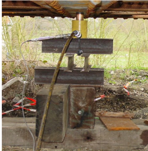
Figure 6.17. Vérin pour la mise en vibration de la structure
