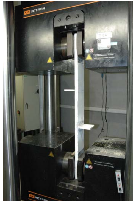
Figure 2.2. Vue générale d'une éprouvette sur le banc de fatigue du LCPC
