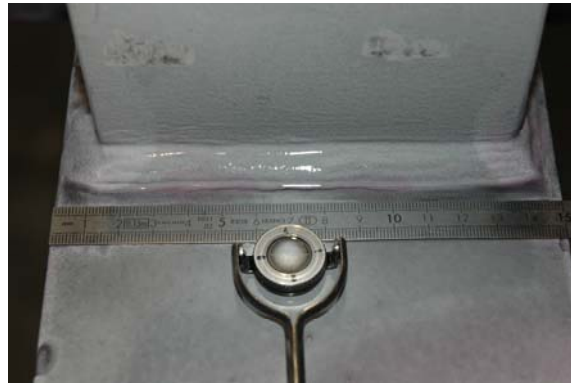
Figure 2.16. Révélation d'une fissure par magnétoscopie à la lumière blanche
