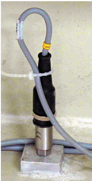
a. Support collé au salicylate de phényle.
