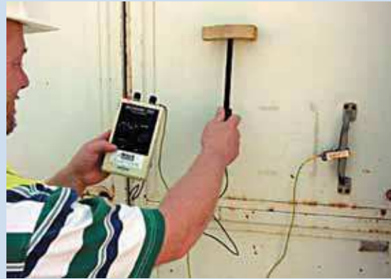
Figure 7 – Détecteur électrique de porosités Appareillage « Éponge humide »
