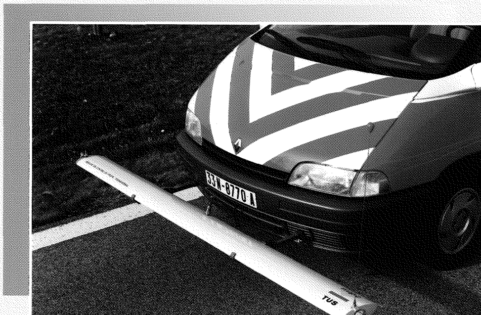
FIGURE 13 LE TRANSVERSOPROFILOMÈTRE TUS.
