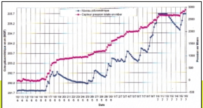
Etude d'un remblai au moyen du capteur PRESOL P
